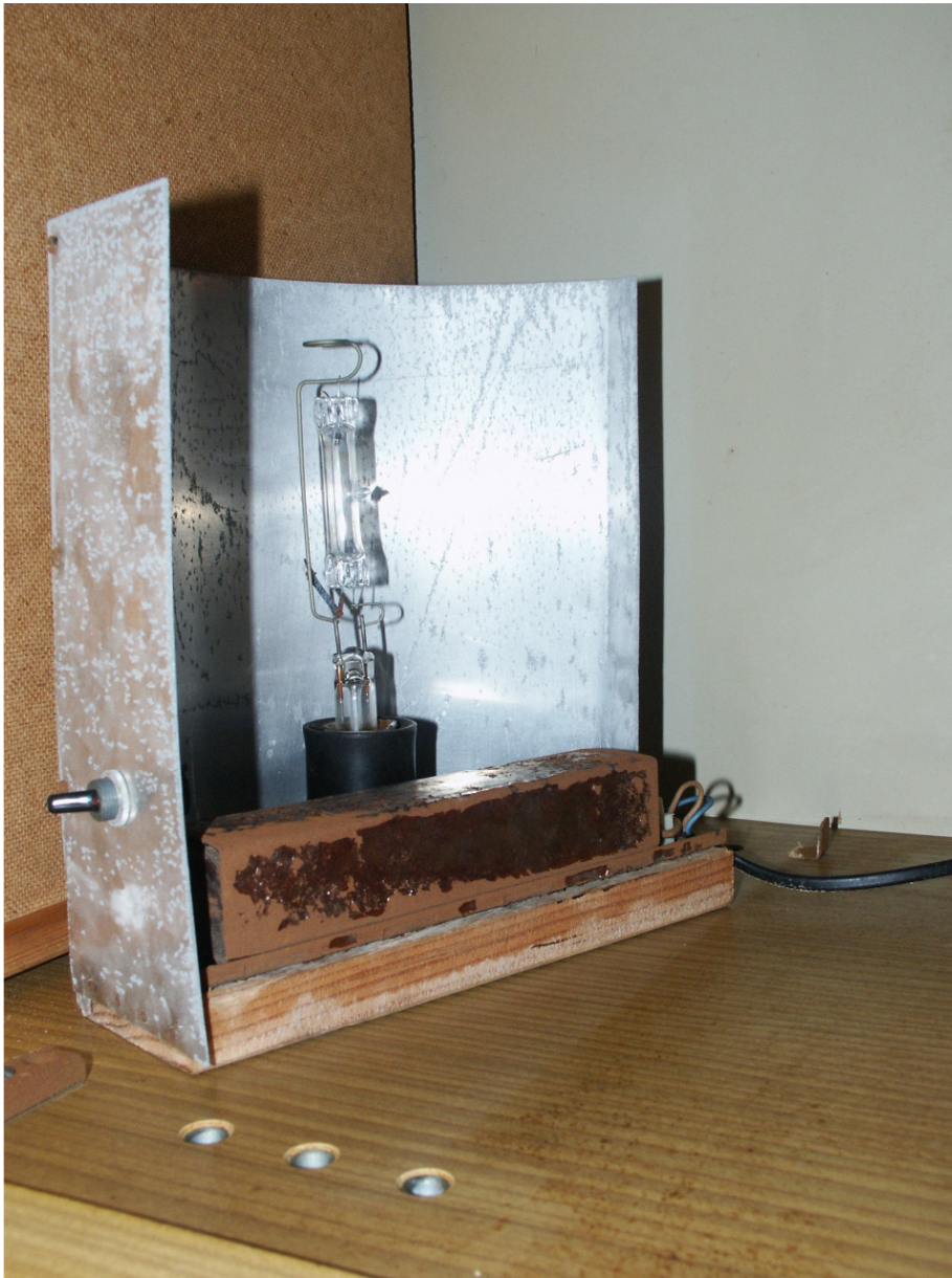
Quecksilberdampf Lampe zum Belichten der Platinen und des Basismaterials
